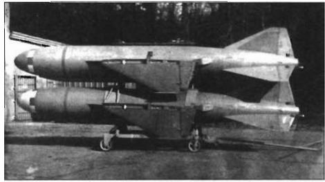
Doppelstocklagerung von Raketen – ein Neuerervorschlag von K.-P. Gödde (PG)
