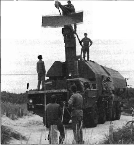
Justieren der Radaranlage „Garpun“ einer SSR in der Startstellung Neuhaus (TK)
