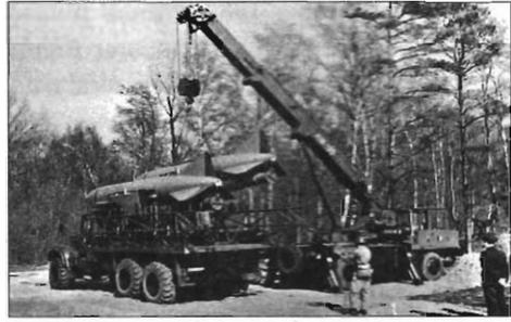
Beladen einer RTE „KRAZ-255 B“ mit Raketen (HN)
