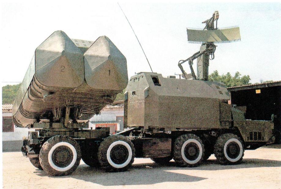
Самоходная пусковая установка 3С51М комплекса «Рубеж». Блок ТПК развернут.
