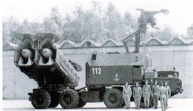
тате которой появилась пусковая установка 3П51М. Главной ее особенностью стало шасси – четырехосное МАЗ-543М, отличавшееся от базовой ЗП51 повышенными характеристиками.
