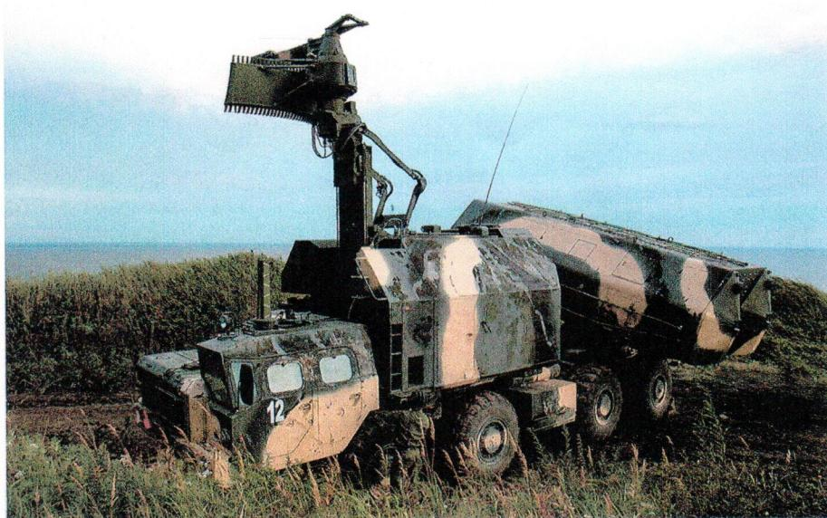
Самоходная пусковая установка комплекса «Рубеж» на огневой позиции. Антенна РЛС «Гарпун» поднята, блок ТПК развернут в боевое положение (фото В. Савицкого).
