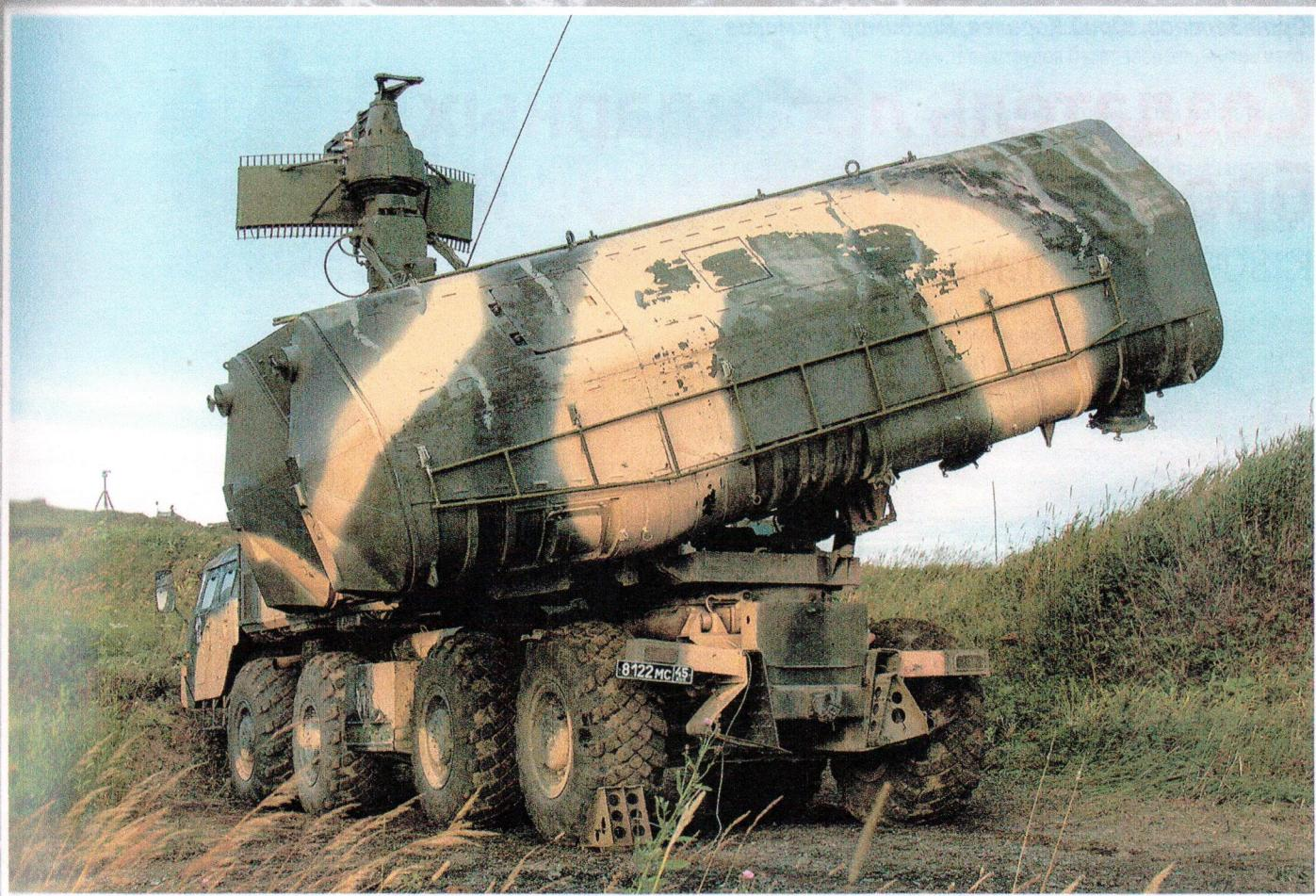
Самоходная пусковая установка комплекса «Рубеж»
