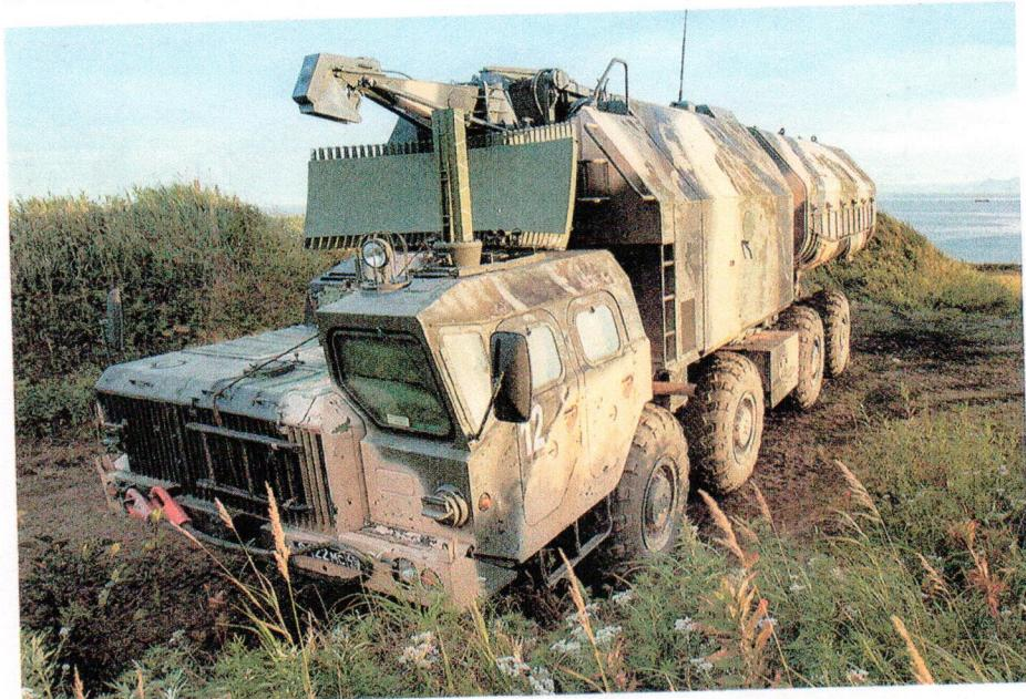
Самоходная пусковая установка комплекса «Рубеж» на огневой позиции перед началом развертывания антенны РЛС «Гарпун» (фото В. Савицкого).
