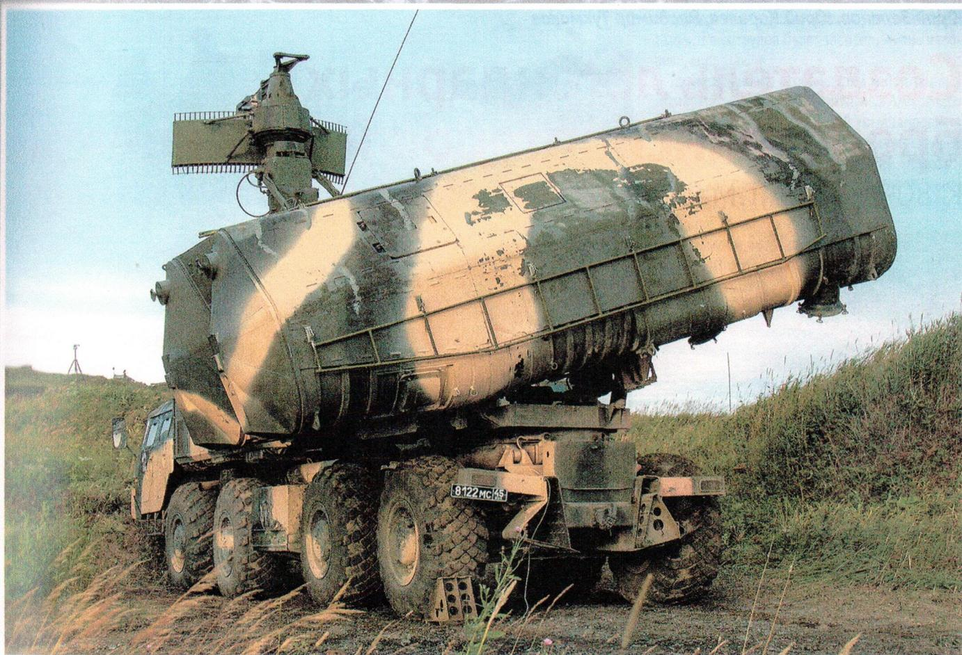
Самоходная пусковая установка комплекса «Рубеж» на огневой позиции. Антенна РЛС «Гарпун» поднята, блок ТПК развернут в боевое положение (фото В. Савицкого).
