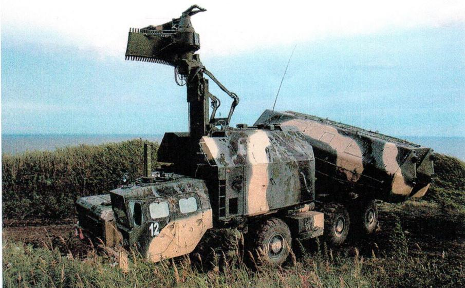
Самоходная пусковая установка комплекса «Рубеж» на огневой позиции. Антенна РЛС «Гарпун» поднята, блок ТПК развернут в боевое положение (фото В. Савицкого).
