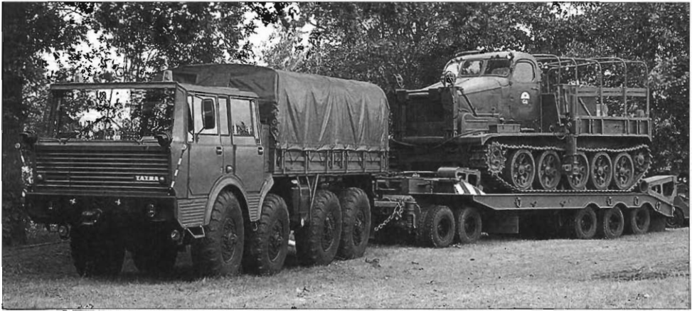
Schweres Radzugmittel „Tatra-813“ mit Tieflader und Pioniermaschine „BAT-M“ (IN)
