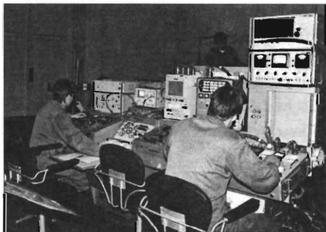
Regelarbeiten an der Rakete mit der stationären Kontroll- und Prüfapparatur „DK-150“ (PG)
