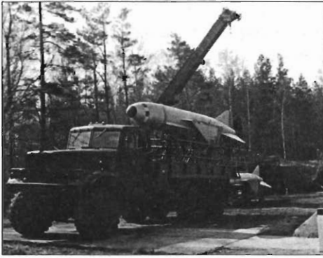
Beladen einer RTE Kfz „KRAZ- 255 B“ mit Raketen durch einen Autodrehkran „ADK-125“ (PG)
