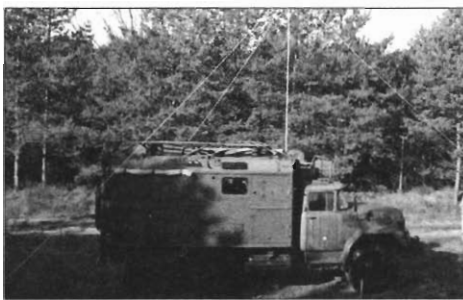
Funkstation „R-140“ auf Kfz „Zil-131“ bei der Arbeit (IN)
