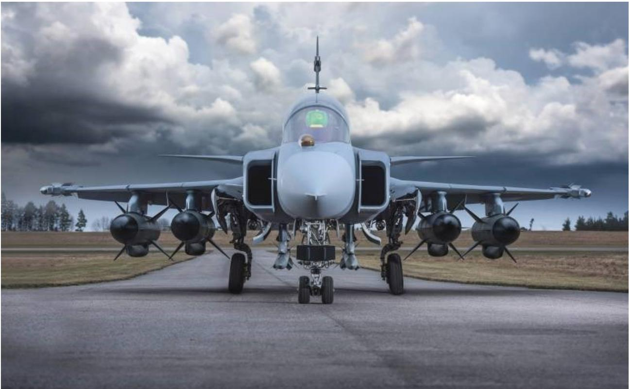
*Saab Gripen E/F-Mehrzweckjäger mit einer Nutzlast von vier RBS15 Mk4 (luftgestützte Variante)*
