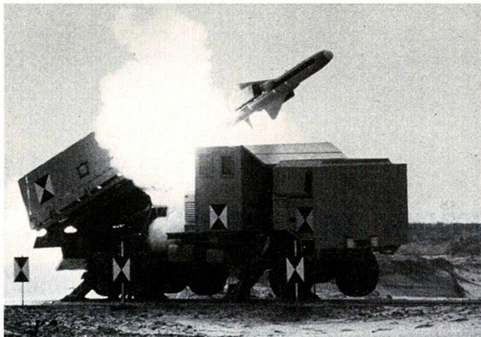
Die landgestützte mobile Version der »Otomat«-FK's der Firma Matra ist inzwischen von Ägypten geordert und erprobt worden. Links die auf Lkw's montierten Start-Container, rechts der Start eines »Otomat«-FK einer mobilen Küstenbatterie. Fotos: Matra
